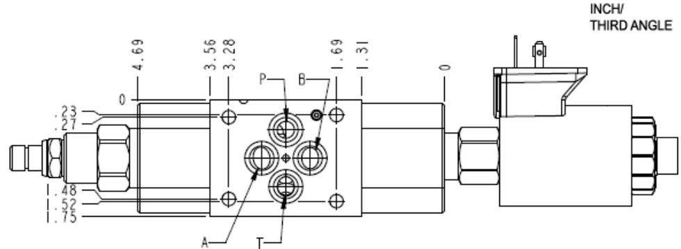
Cet ensemble consiste en un réducteur de pression piloté à 3 voies avec drain indépendant (chambre 4) qui réduit la pression primaire élevée de l'entrée (chambre 2) en une pression réduite constante dans la chambre 1, et fonctionne en limiteur de pression capable du plein débit de
